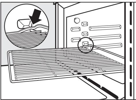
■ Как только решётка при выдвижении упрётся в фиксаторы, слегка приподнимите её спереди.
